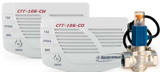
Предназначена для непрерывного автоматического контроля содержания природного или сжиженного газов по BS EN 5091-1-2010+F1-2012 и оксида углерода по ГОСТ EN 50194-1 в воздухе контролируемых помещений; выдачи световой и звуковой сигнализации в случае возникновения пороговых значений; перекрытия газопровода быстродействующим электромагнитным клапаном.
